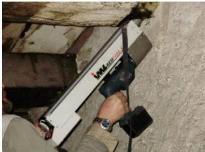
I grafici (resistogrammi) ottenuti rappresentano in ascissa la profondità di perforazione ed in ordinata la resistenza opposta dal legno alla perforazione; l'interpretazione viene effettuata per confronto con resistogrammi di specie legnose note.
